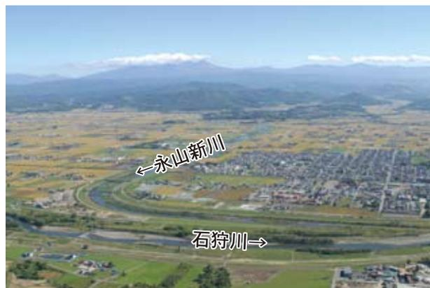
永山新川の完成で昭和 45 年 8 月洪水と同程度の浸水被害を防止することが可能 (旭川開発建設部蔵)
