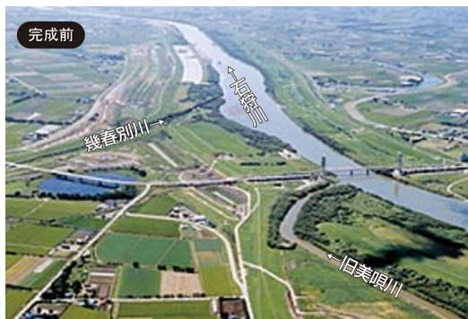
幾春別川と旧美唄川を合わせ、石狩川への合流点を下流へ移す
