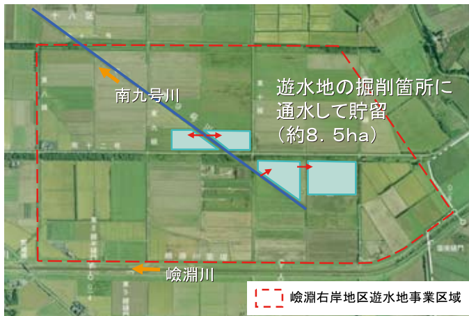
平成 21 年 9 月降雨で工事中の長沼町の遊水地掘削箇所へ洪水を緊急通水 *資料—札幌開発建設部の公式ホームページに公開された資料より
