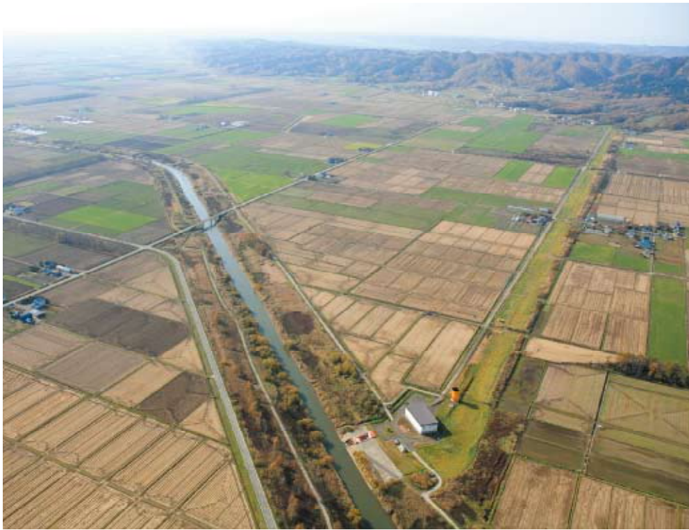
平成18年疎水百選「篠津運河」。広大な泥炭地に運河を掘削し開田したのは世界でも例がない (出典：全国水士里ネット「水士里デジタルアーカイブ」より)
