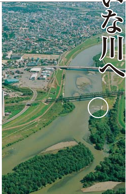
流量の大きい石狩川で放流し、希釈効果を高めた（完成した流水保全水路放流口）
